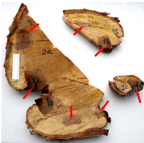
Рисунок 1 – Поперечный спил комля березы со старыми ранами после подсочки и участками дисколорации (отмечены стрелками)
