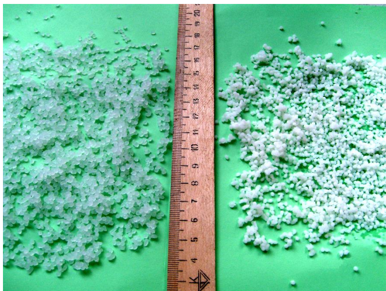
Рисунок 1. – Фотография капсул-жемчужин, полученных на основе альгиновой кислоты: пустые (слева) и содержащие эфирное масло душицы (справа)
