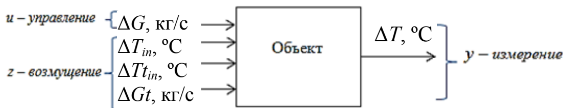
Рис. 4. Упрощенная параметрическая схема агрегата регулирования теплотехнического режима электротехнологической водоочистки
