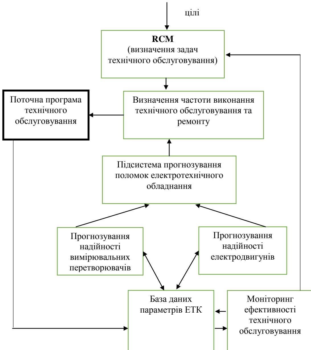
Рис.2. Структура системи реалізації програми технічного обслуговування
