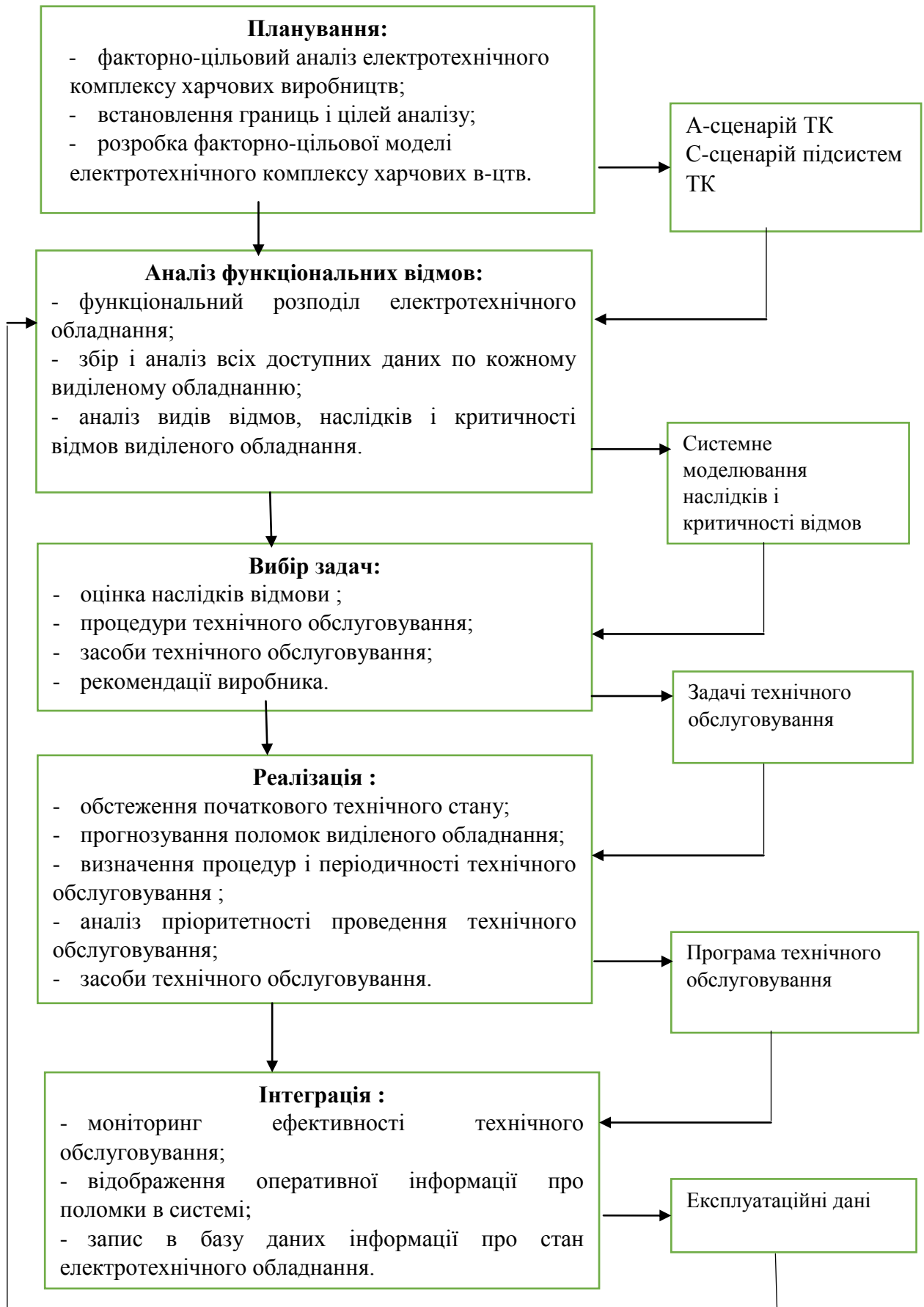
Рис. 1. Процес RCM для електротехнічних комплексів харчових виробництв
