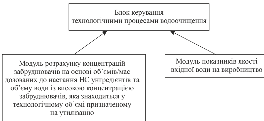
Рис. 5. Структура подання додаткової інформації на блок керування водоочищенням (режим нештатної ситуації)
