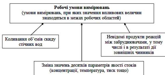
Рис. 1. Схема впливу негативних непередбачуваних чинників на робочі умови вимірювання якості стоків
