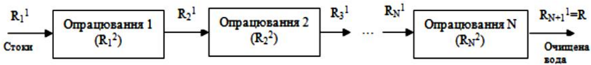
Рис. 2. Схема послідовного технологічного ланцюга очищення стічних вод: R_N^1 – рівень привнесеного ризику виникнення НС і перевитрат ресурсів відповідної ланки, R_N^2 – рівень власного ризику виникнення НС і перевитрат ресурсів відповідної ланки, N – кількість ланок (блоків водоочищення), R – рівень ризику виникнення НС і перевитрат ресурсів усієї системи водоочищення
