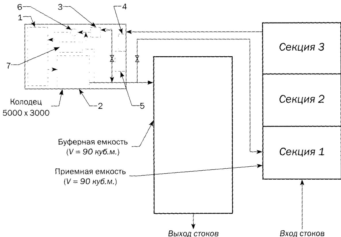
1 — батарея электрохимических окислителей, 2 — деаэратор-электролизер, 3 — электрокоагулятор, 4 — блок управления, 5 — источник питания, 6 — кавитационный модуль, 7 — гипохлоритная установка
