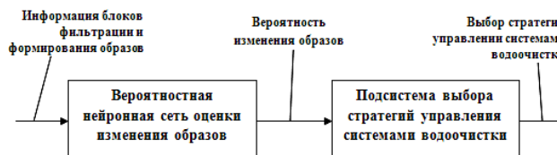
Рисунок 3 – Структурная схема использования вероятностной нейронной сети при управлении комбинированными системами водоочистки
