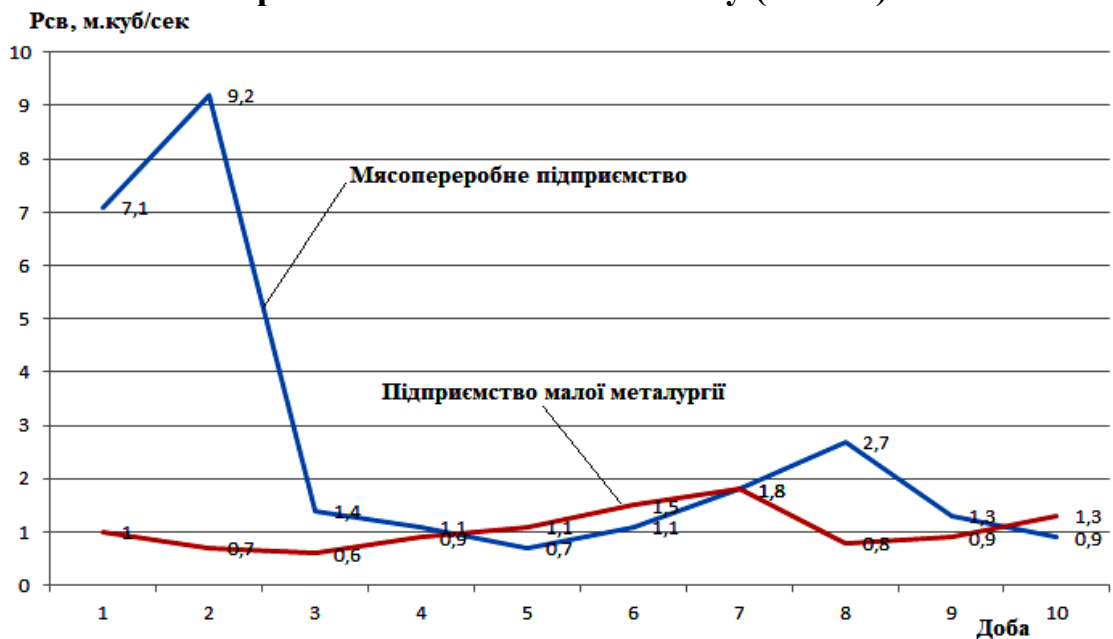
Рис. 6. Оперативний аналіз антропогенного навантаження (скид неочищених стічних вод) при корегуванні функціонування очисних споруд з метою зменшення тиску на довкілля (із використанням електротехнологічного комплексу (ВМЕВ))
