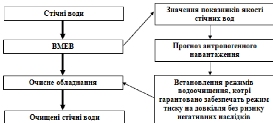
Рис. 4. Схема електротехнологічного комплексу (ВМЕВ) для оперативного аналізу складу промислових стічних
