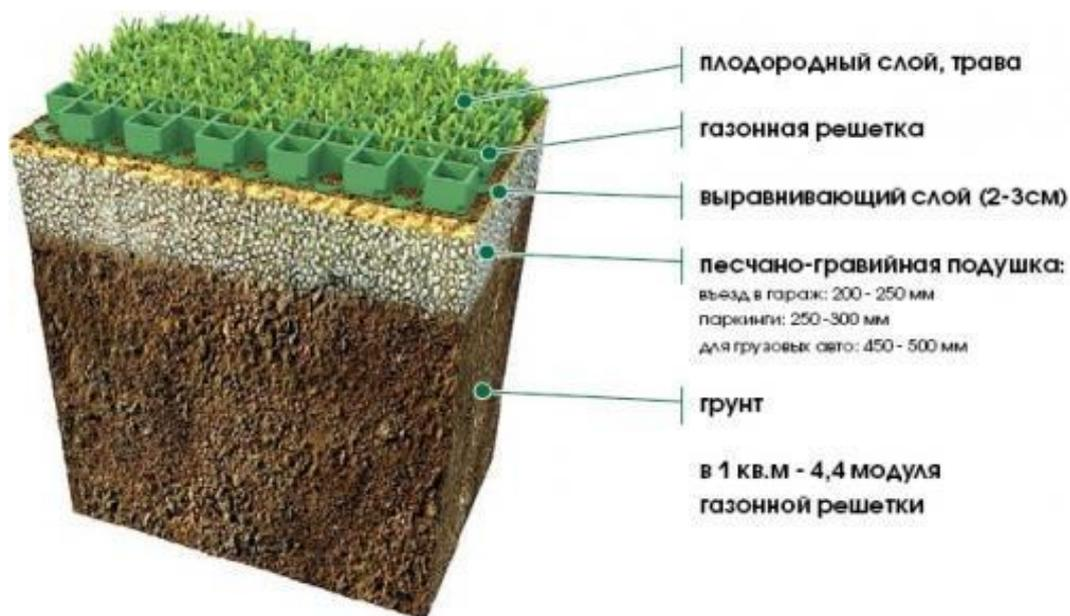
Рисунок – Строение экопарковки в разрезе
