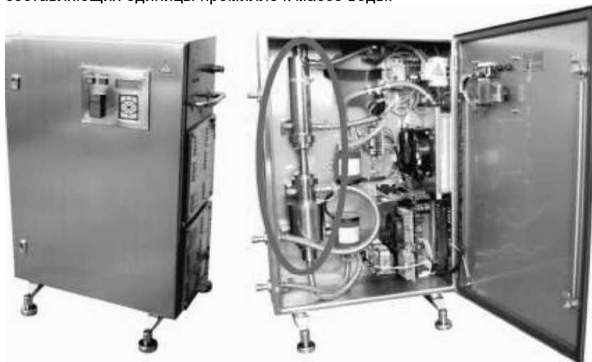
Рис. 1. Внешний вид и внутреннее устройство установки сонохимической обработки посолочных растворов для мясных кулинарных изделий с кавитационным реактором по ТУ 5130-002-26784341-08 (выделен овалом)
