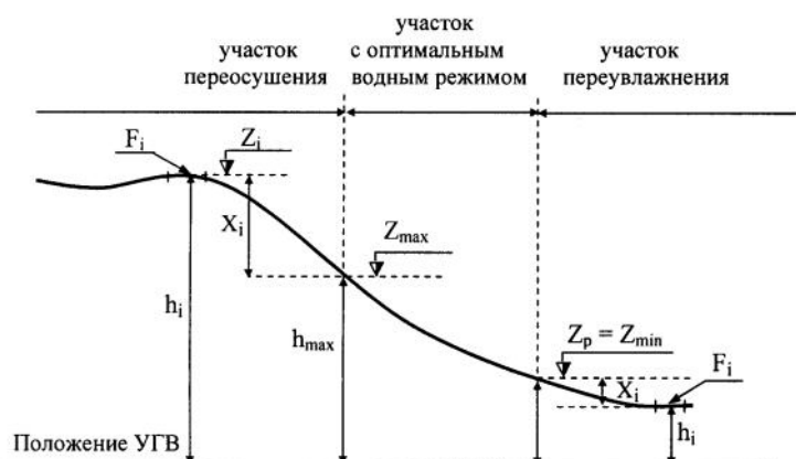
Рис. 1. Схема к определению расчетной отметки поверхности почвы
