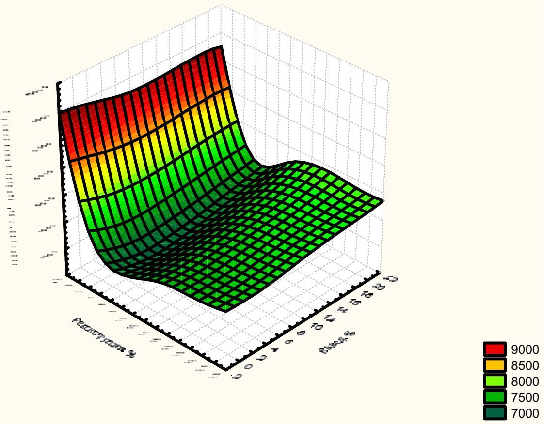
Рисунок. Зависимость приведенных затрат на реконструкцию и эксплуатацию мелиоративных систем с учетом объемов вывода из оборота мелиорированных земель.
