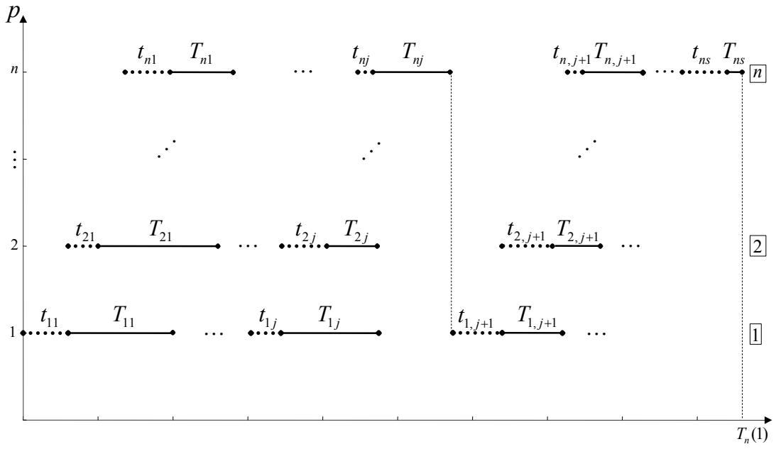
Рисунок 1. – Несовмещенная диаграмма Ганта с одним каналом обмена
