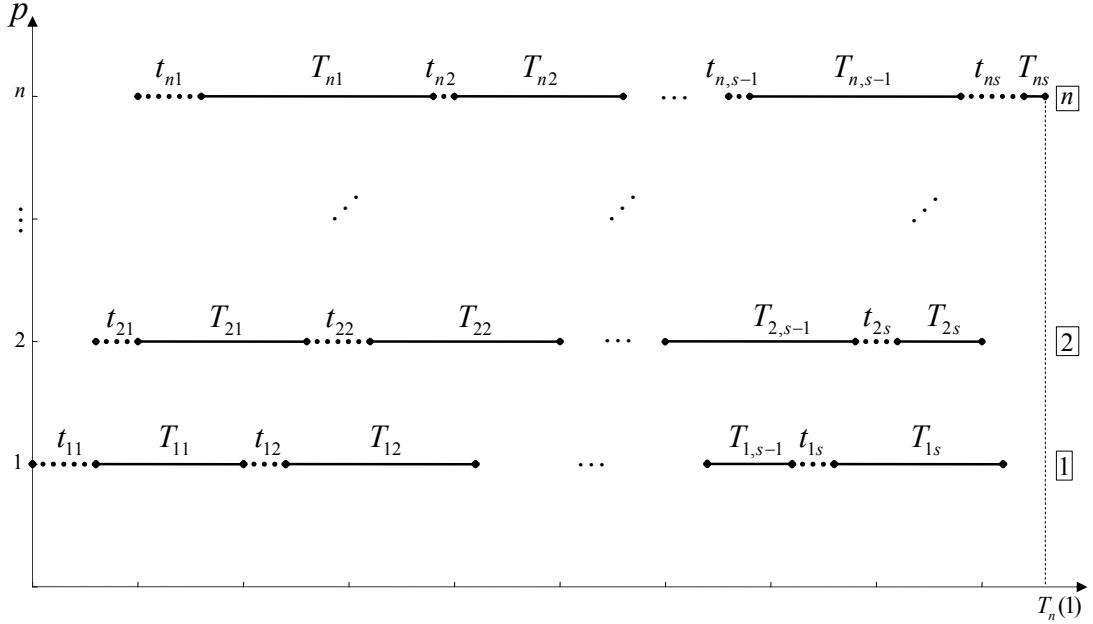
Рисунок 2. – Совмещенная диаграмма Ганта с одним каналом обмена
