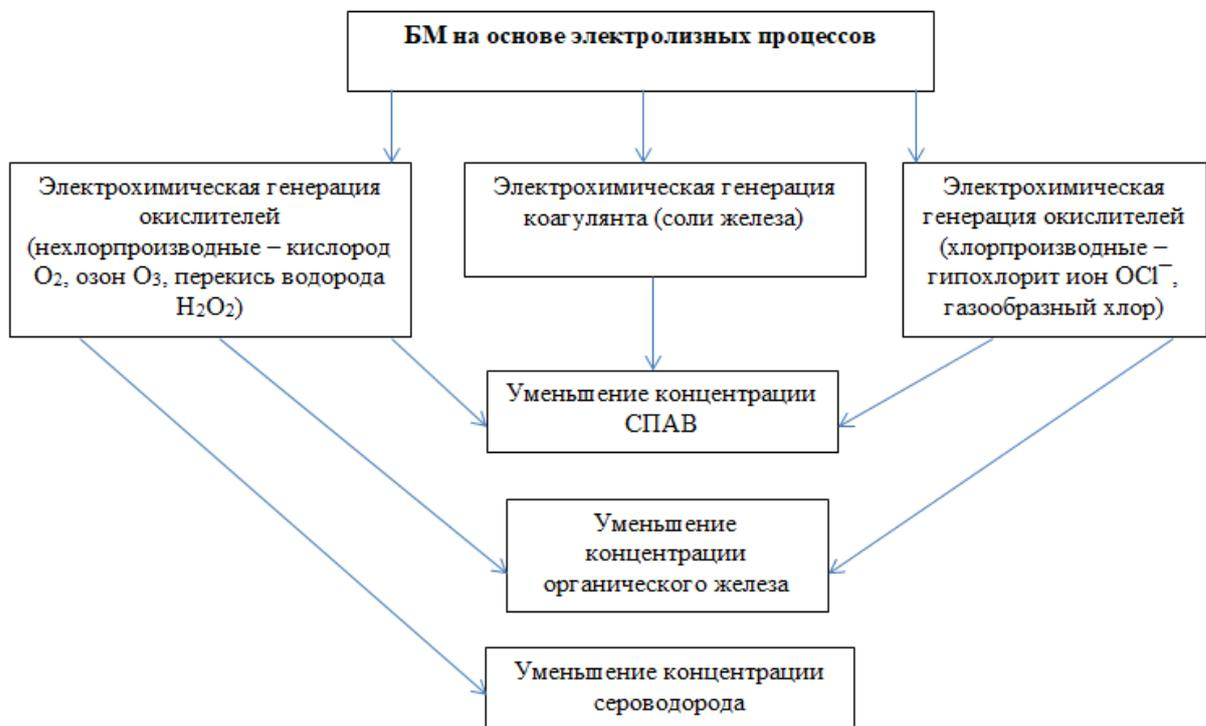
**Рис. 1. Структура воздействия электролизно-сгенерированных окислителей и коагулянтов на поллютанты при реализации БМ водоочистки на исследуемых объектах**
