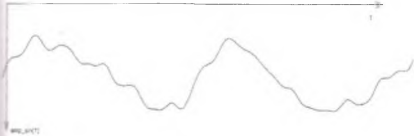
Рисунок 1 – Фрагмент дрейфующей синус-амплитуды первой моды ( \omega_1 = 0.023 ) (Дрейфующая косинус-амплитуда принципиально такая же)
