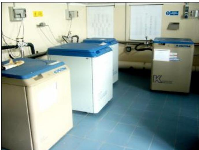
**Рисунок 68. - Лаборатория криогенных аппаратов. В изолированном помещении располагаются вдоль стены аппараты газообразного азота, позволяющие сохранять культуры клеток при температуре – 150°С.**
