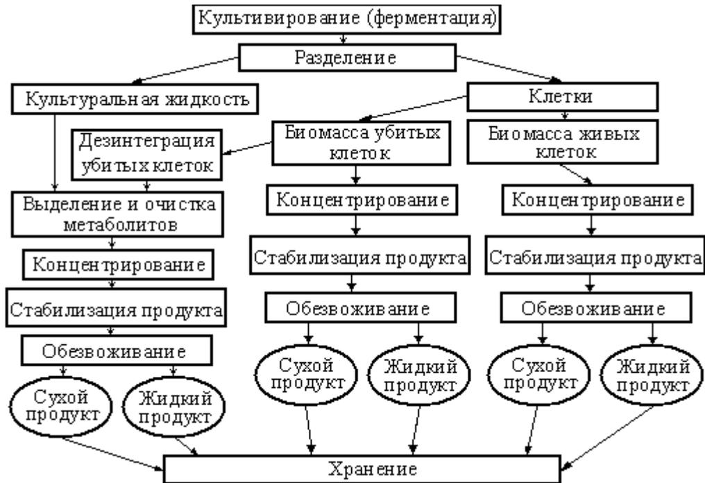
Рисунок 43. - Система биотехнологического производства
