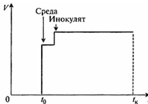
**Рисунок 54. - Изменение объема жидкости во времени при переодическом способе ферментации**
