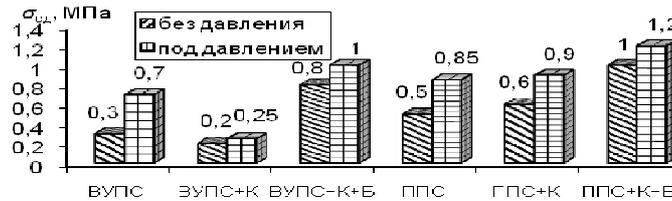
Рис. 2. Предел прочности при сдвиге бетонных образцов, склеенных адгезивом на основе разработанных материалов
