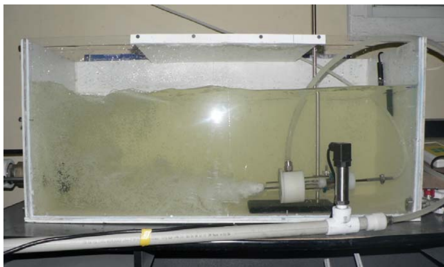
Рисунок 3. – Общий вид работающего вихревого гидравлического аэратора
