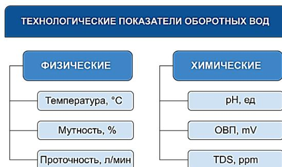
Рис. 1. Технологические показатели качества оборотной воды контролируемые АИК
