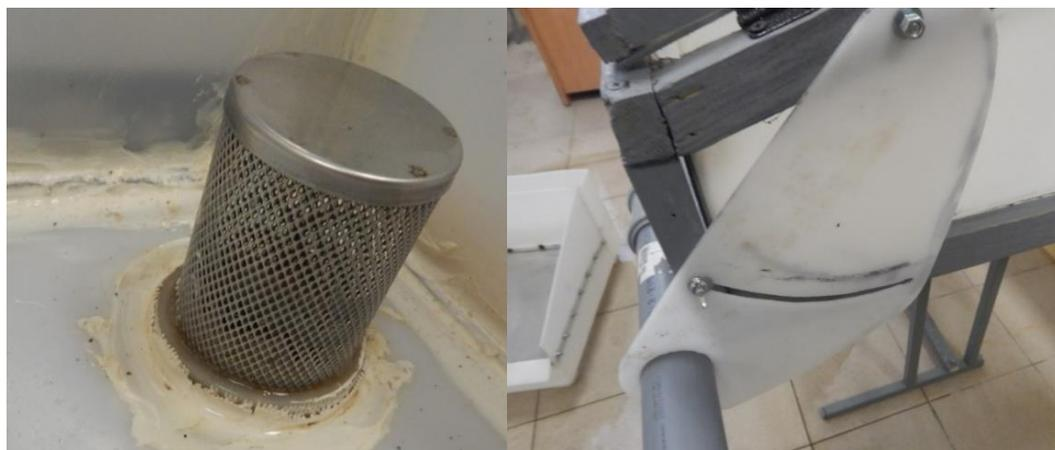
**Рисунок 3.7.– Водосливная система аппарата для выращивания личинок сома**
