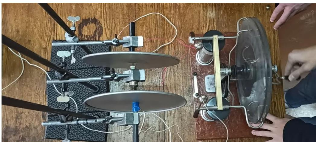
Рисунок – Проверка свечей зажигания
