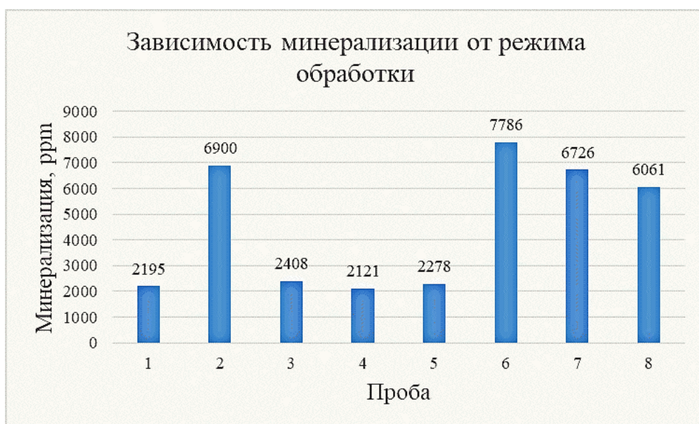
Рисунок 4 – Графические зависимости значения показателя качества сточных вод текстильного производства «Минерализация» (ПДК = 1000 мг/л) от режимов обработки: 1–8 – варианты воздействия на СВ, описанные в методике экспериментальных исследований
