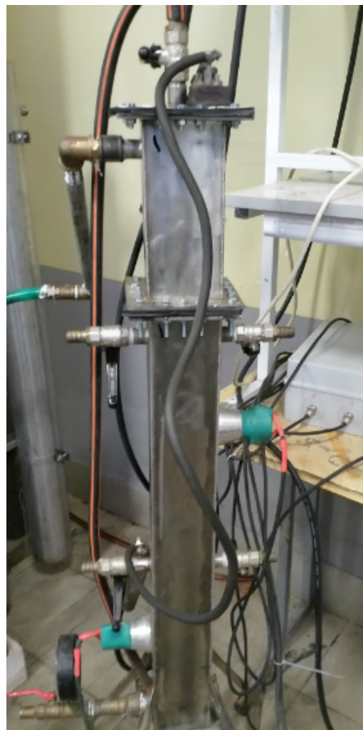
Рисунок 1 – Внешний вид электролизной установки с комбинацией ультразвуковой обработки сточных вод
