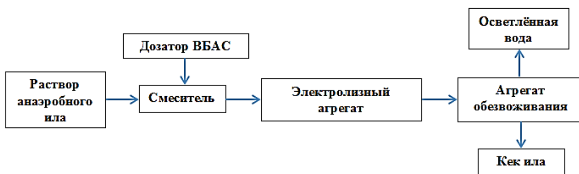
Рисунок 3. – Структурная схема комбинированной утилизации анаэробного ила с использованием ВБАС и электролизных процессов
