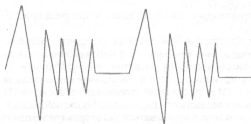
Рис. 2. Схематическое изображение токов, подаваемых на индуктор магнитотерапевтического аппарата "Гемоспек"
