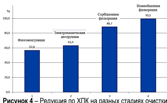
Рисунок 4 – Редукция по ХПК на разных стадиях очистки
