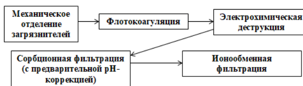
Рисунок 2 – Технологическая схема реализации очистки высококонцентрированных сточных вод рыбоперерабатывающего предприятия
