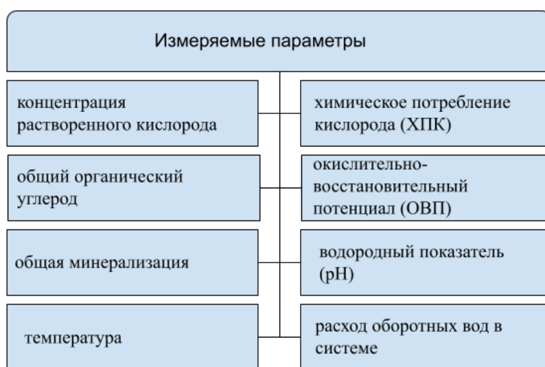
Рисунок 3. Технологические параметры измеряемые ИИС в УЗВ
