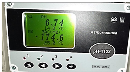
Рисунок 2. – Схема подключения системы мониторинга параметров водоотведения предприятия по производству солода и внешний вид дисплея блока рН/ОВП-метра
