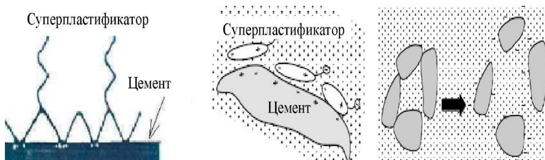
Рисунок 2. – Пластикация на растворимых цементных частицах
