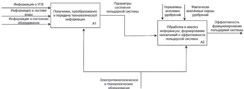
Рис. 2. Диаграмма декомпозиции контекстной диаграммы контроля состояния польдерной системы
