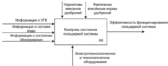
Рис. 1. Контекстная диаграмма контроля состояния польдерной системы
