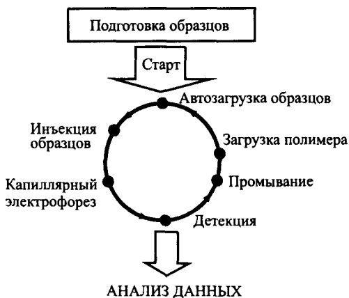
Рис. 16.12. Схема проведения секвенирования на генетическом анализаторе
