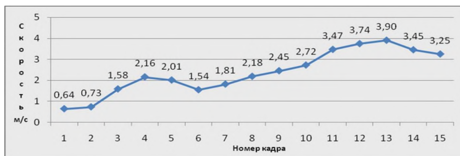
Рисунок 2 – Динамика скорости верхней точки упругого элемента в процессе его разгибания
