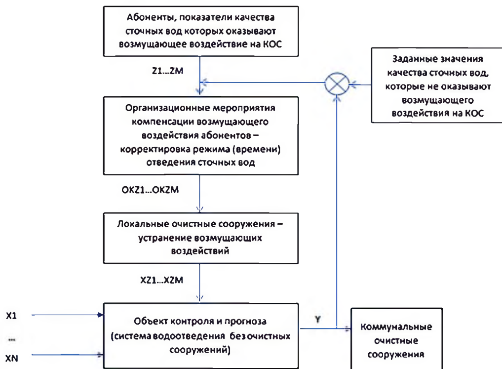
Рис. 8. Концептуальная модель цифровизации системы водоотведения водопроводно-канализационных хозяйств в сегменте «транспортировка – очистка сточных вод» на основе критерия экологической эффективности очистных сооружений в рамках регулирования параметров водоотведения по возмущению: X_1...X_N – показатели качества сточных вод от бытовых и промышленных абонентов, сточные воды которых не оказывают возмущающего воздействия на технологические процессы на КОС; Z_1...Z_M – показатели качества сточных вод от бытовых и промышленных абонентов, сточные воды которых оказывают возмущающее воздействие на технологические процессы на КОС; ОКZ_1...ОКZ_M – показатели качества сточных вод от бытовых и промышленных абонентов, сточные воды которых оказывают возмущающее воздействие на технологические процессы на КОС после организационных мероприятий коррекции такого негативного влияния, КОС; XZ_1...XZ_M – показатели качества сточных вод от бытовых и промышленных абонентов, сточные воды которых оказывают возмущающее воздействие на технологические процессы на КОС после коррекции такого негативного влияния с помощью подходов локальной очистки сточных вод;
