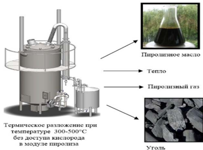
Рисунок – Схема установки для термической переработки отходов со свиноводческих ферм
