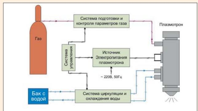
Рис. 5. Структурная схема системы энергопитания плазмотрона
