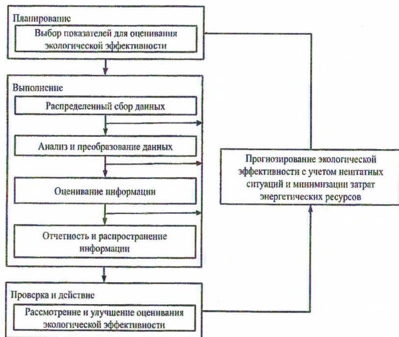
Рисунок 2 – Методика определения эколого-энергетической эффективности водопроводно-канализационных хозяйств с учётом возможности возникновения чрезвычайным ситуациям на водных объектах
