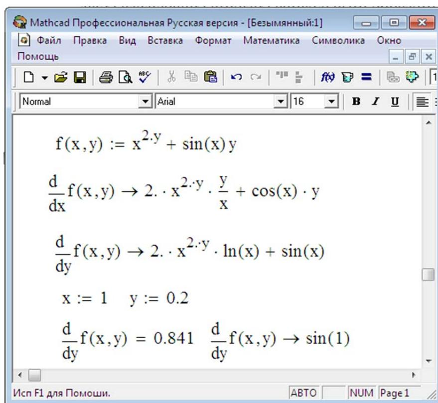
Рис. 14. Вычисление частных производных
