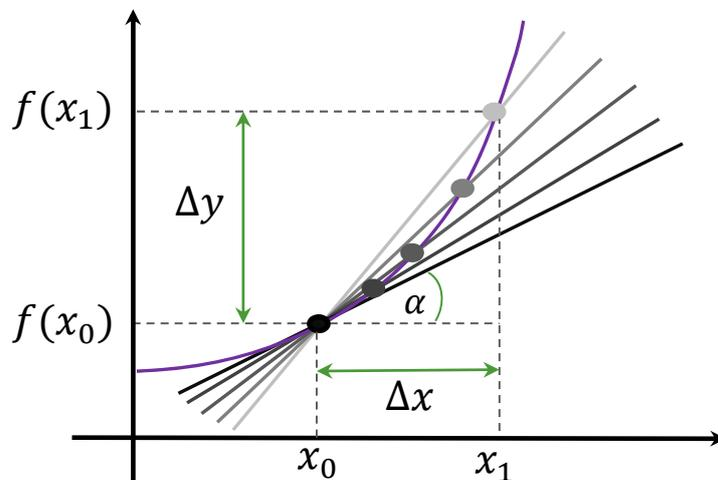
Рис. 1. Секущие и касательная к графику функции  $y = f(x)$  в точке  $x_0$
